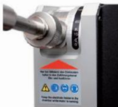
Plato centralizador triplica el uso del disco de diamante.
