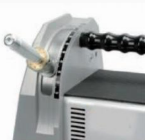
Ángulo de afilado de 7.5- 90° creando una punta adecuada con ángulos de 15 - 180°.
