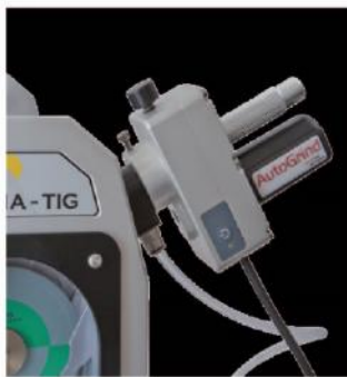
Modulo de afilado - rotación automatica de lo soporte de electrodo
