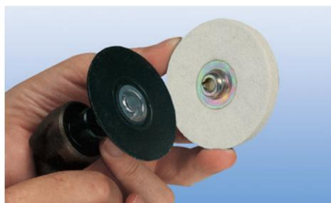
Fijar el disco de fieltro girando ligeramente con la mano hacia la izquierda. La rosca funciona suavemente incluso después de duro trabajo.
