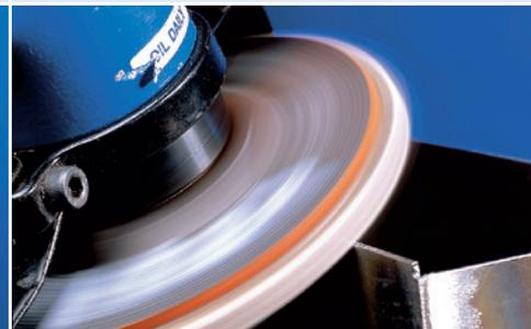
Lijado exacto en superficies de contacto extremadamente pequeñas con alto arranque de material y estabilidad y larga vida útil del disco.
