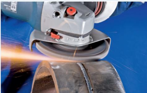
Lijado rápido con arranque de material máximo y moderada generación de calor.
